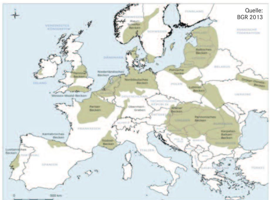
Schematische Darstellung geologischer Becken mit möglichem Schieferöl- und Schiefergas-Potenzial.
